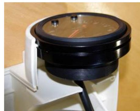
Connectez le capteur et l'alimentation électrique aux prises d'origine (voyez aussi le schéma de câblage).
