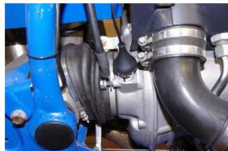
Faites passer le câblage du capteur de vitesse le long du cadre et le fixez avec des attaches de câble. Boulonnez l'expéditeur électronique à la boîte de vitesses selon le câble speedo d'origine. Attachez l'extension et la posez le long du faisceau électrique et la faites passer au travers de l'entrée de câbles.
